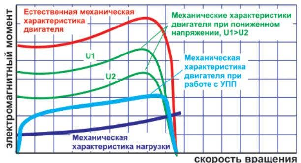
Механические характеристики двигателя при изменении напряжения
