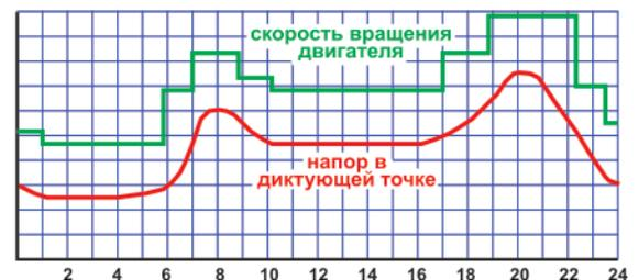
Еще один пример использования расписания – системы кондиционирования, которые должны обеспечивать микроклимат в помещении, например с 7 до 18 часов, а остальное время могут быть отключены. Работа преобразователя частоты или устройства плавного пуска с использованием расписания позволит решить эту задачу без участия оператора!
