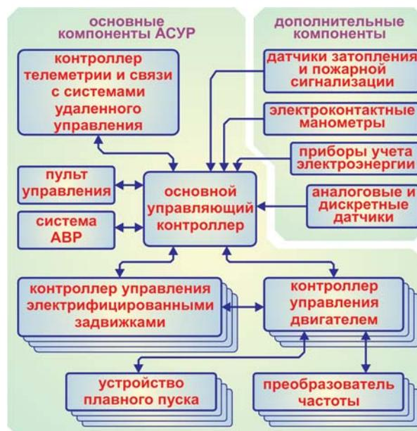
Для контроля соблюдения безопасных режимов и обеспечения требуемых технологических параметров работы объекта, к АСУР могут быть подключены любые датчики:
