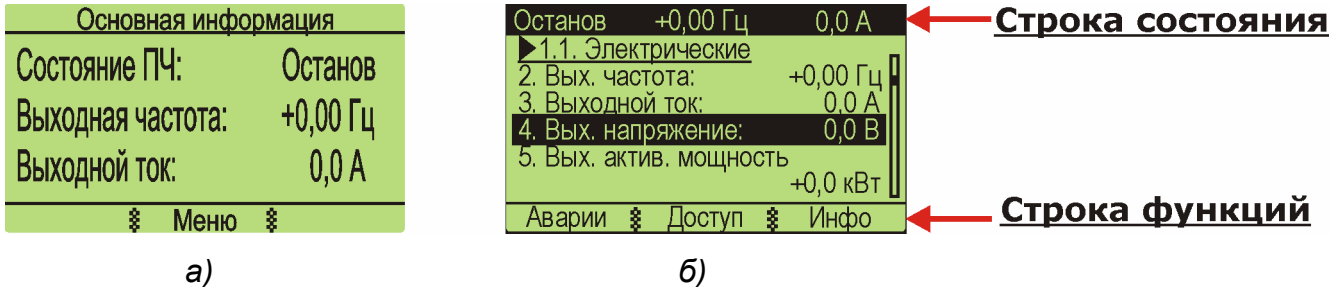
Рисунок 5 – Примеры меню преобразователя: а) экран состояния; б) основной экран
